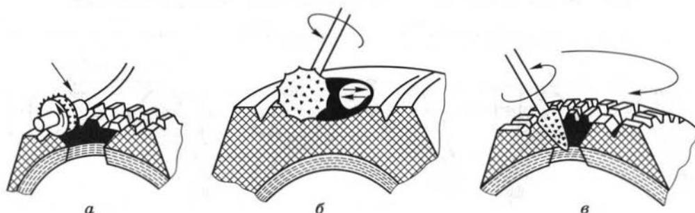
**Рис. 3.14.** Способы шероховки поврежденных мест при ремонте шин:
