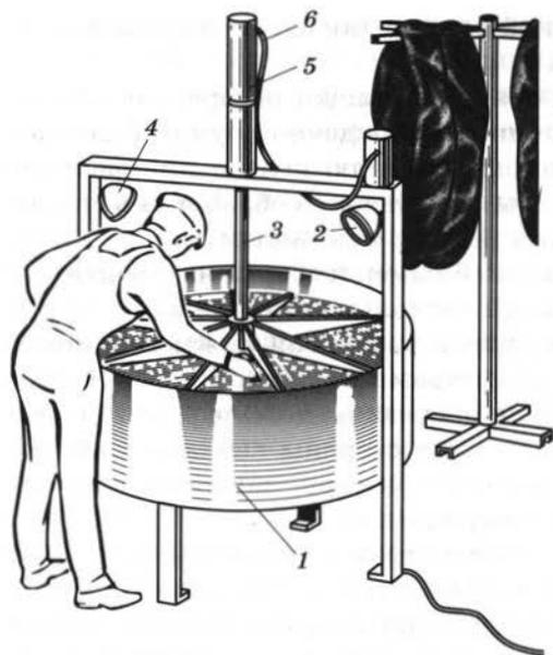
**Рис. 3.11.** Применение ванны для проверки герметичности камер:
