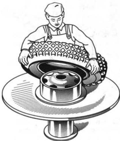
**Рис. 3.5. Монтажно-демонтажный вращающийся стол (высота над уровнем пола 500 мм)**
