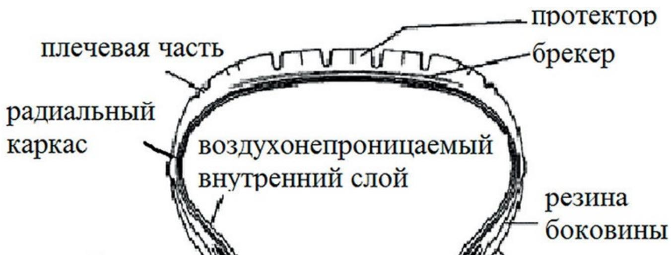
Рис. 25. Устройство бескамерной шины
