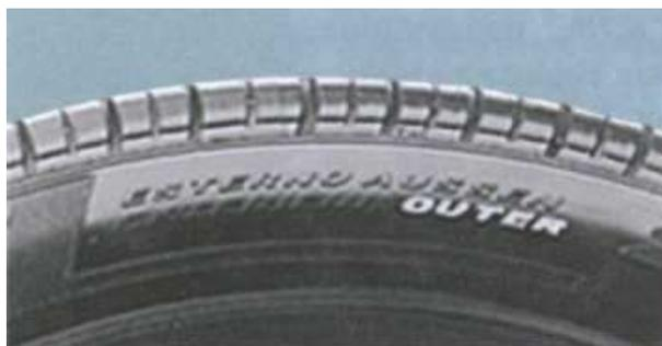
*Рис. 4.12.* Гравировка на наружной боковине шины с асимметричным рисунком протектора (outer - внешняя сторона)
