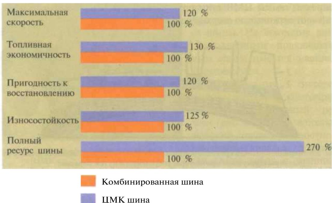
**Рис. 6.10.** Преимущества ЦМК шин по сравнению с комбинированными шинами
