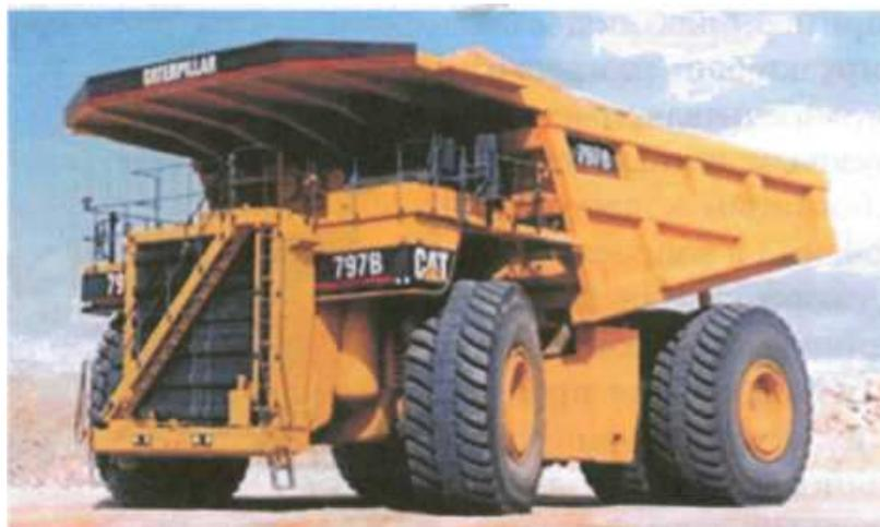
*Рис. 3.2. Карьерный самосвал на сверхкрупногабаритных шинах*
