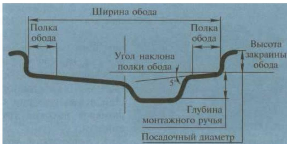
Рис. 9.2. Основные элементы неразборного обода пневматической шины
