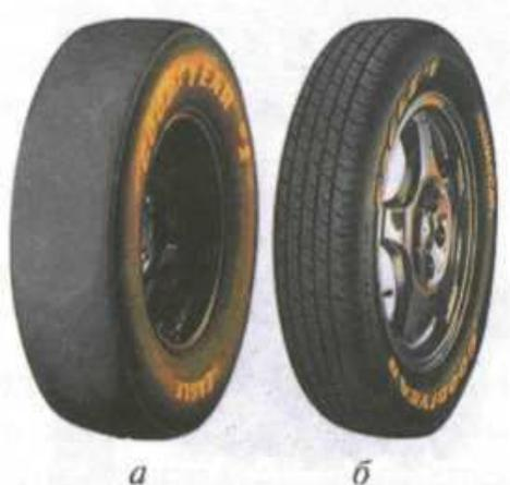
**Рис. 3.6.** Гоночная (а) и обычная дорожная (б) шины «Игл» («Eagle») фирмы Goodyear
