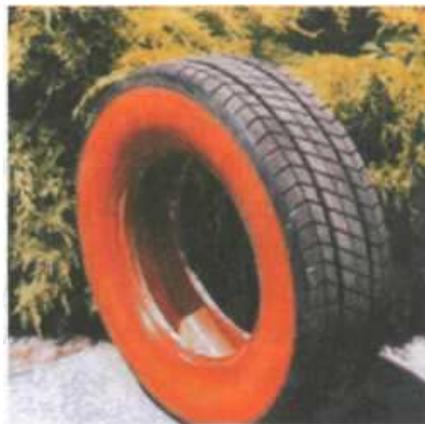
*Рис. 3.10.* Шина с литым полиуретановым каркасом и резиновым протектором
