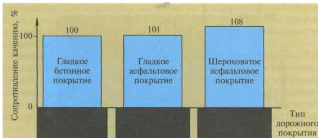
Рис. 7.6. Влияние дорожного покрытия на сопротивление качению
