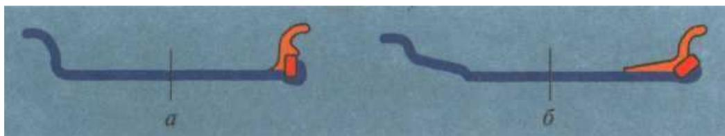
Рис. 9.7. Профиль разборного «плоского» обода (а) и обода с коническими полками (б)
