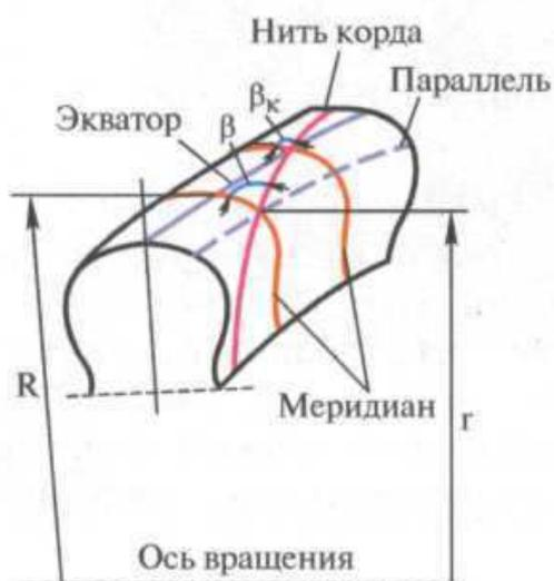
**Рис. 6.2.** Схема расположения нити корда в слое корда каркаса диагональной шины:
