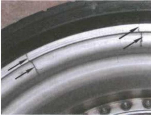
Рис. 9.12. Трещины на ободе колеса
