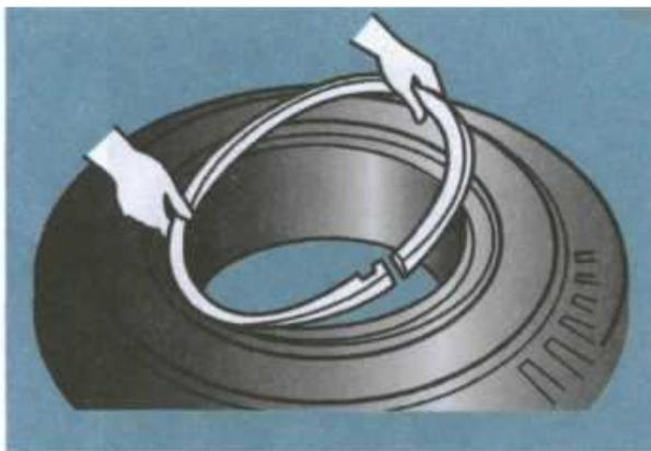
**Рис. 9.4.** Установка запорного кольца при монтаже шины на разборный обод
