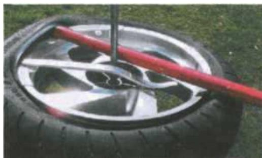
**Рис. 9.5.** Деформирование борта шины в процессе монтажных работ
