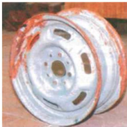
*Рис. 9.17.* Коррозия стального
