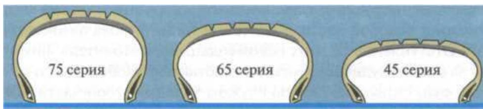
Рис. 6.14. Низкопрофильные шины разных серий с одинаковым посадочным диаметром
