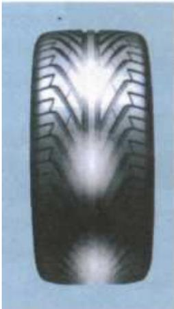
Отклонение **углов установки колес** от нормы — причина неустойчивого движения автомобиля («увода», «рысканья»), неравномерного и преждевременного износа шин (*рис. 7.34*), деталей подвески, а также повышенного расхода топлива.
