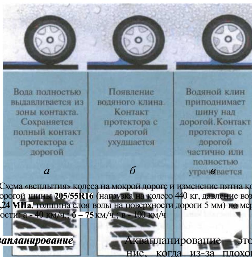
**Рис. 7.24.** Схема «всплытия» колеса на мокрой дороге и изменение пятна контакта с дорогой шины **205/55R16** (нагрузка на колесо 440 кг, давление воздуха в шине **0,24 МПа**, толщина слоя воды на поверхности дороги 5 мм) по мере роста скорости: а - 40 км/ч.; б - 75 км/ч.; в - 100 км/ч
