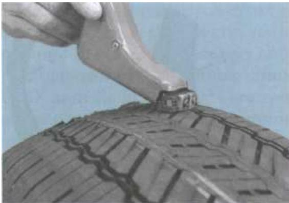
**Рис. 6.7.** Углубление рисунка протектора путем нарезки электрообогреваемым ножом
