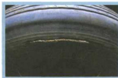
**Рис. 7.11.** Разрыв боковины шины из-за езды с перегрузкой
