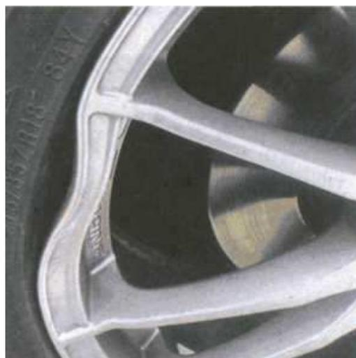
Рис. 9.11. Деформация закраины обода колеса
