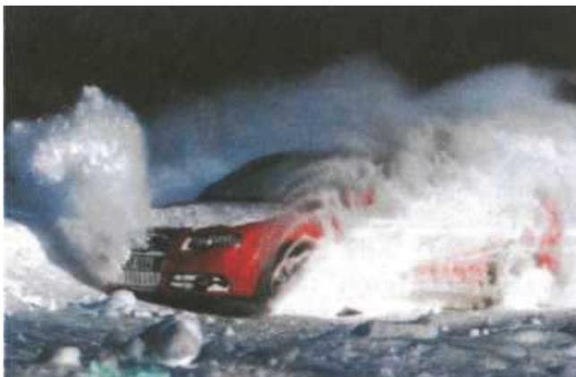
**Рис. 7.28.** Пониженное сцепление шины с дорогой при движении по снежно-водяной каше (слашпленинг)
