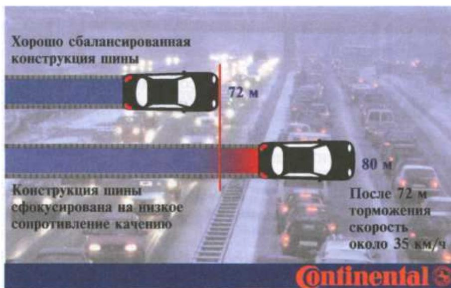
**Рис. 7.39.** Тормозной путь на мокрой дороге со скоростью 100 км/ч хорошо сбалансированной конструкции шины (вверху) и шины (внизу), конструкция которой сфокусирована на снижение потерь на качение
