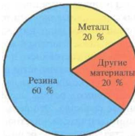
*Рис. 5.1.* Основные материалы, применяемые для производства типичной пневматической шины
