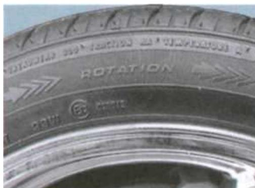
Рис. 4.10. Гравировка на боковине шины с направленным рисунком протектора
