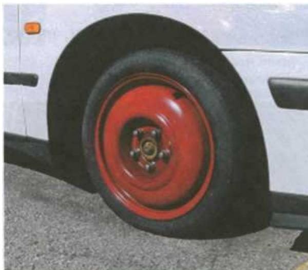
**Рис. 3.7. Запасная шина, установленная взамен обычной**
