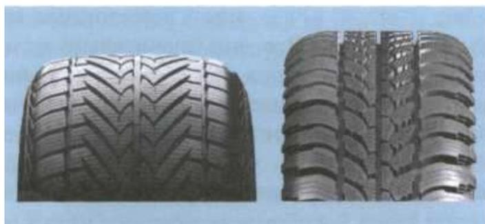
**Рис. 4.6.** Зимние фрикционные шины Amtel-Vredestein моделей WinTrac Xtreme и NordMaster CL
